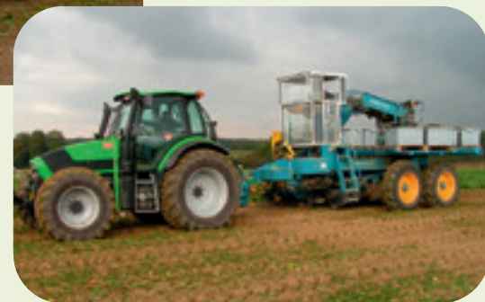
Machines voor de rooi van proefpercelen. De eerste machine ontbladert 6 rijen en verwijdert de bieten van rij 1 en 6 van elk klein perceel. De tweede machine rooit de 4 centrale rijen waarop de opbrengstmetingen worden gedaan.
