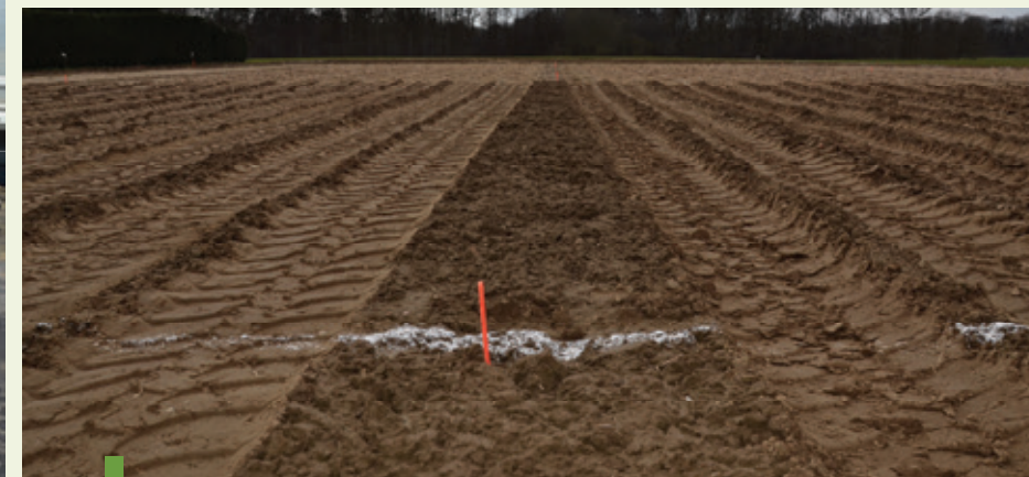
Figuur 6: doorgangen in proef van 2018 met zelfde machines als 2019. Links: trekker + aanhang-er op lage bandenspanning, rechts: trekker + aanhang-er op hoge bandenspanning. Verschil in diepte insporing is heel duidelijk zichtbaar.
