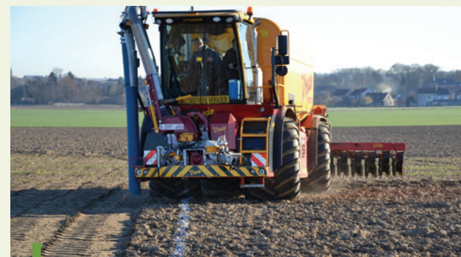
Figuur 2: Zelfrijder hier in hondengang. Dezelfde machine werd ook gebruikt in lijn, waarbij ieder spoor tweemaal een bandendoorgang kent.
