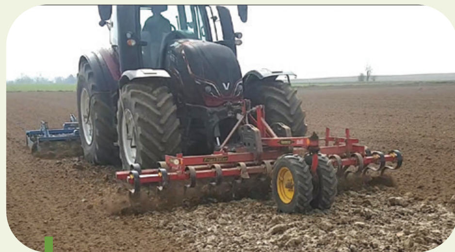
Figuur 1 Door frontwerktuigen beperk je het aantal doorgangen. De betere gewichtsverdeling in combinatie met een luchtdrukswisselsysteem vermindert de druk op de bodem
