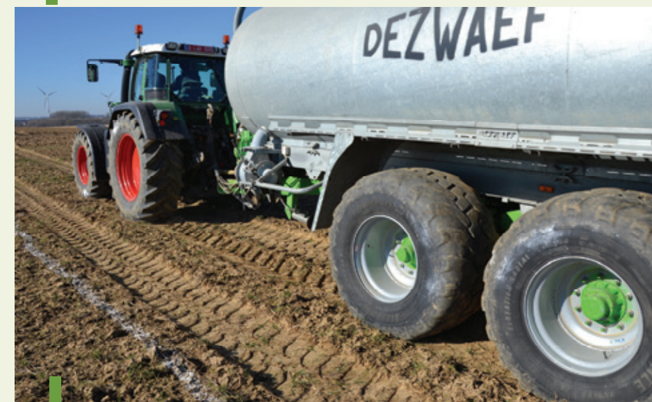
Figuur 3: Trekker + aanhang-er op hoge bandenspanning (trekker 2,4 bar, aanhang-er 4 bar). Dezelfde machine werd gebruikt op lage bandenspanning (trekker 1,4 bar, aanhang-er 1,5 bar).
