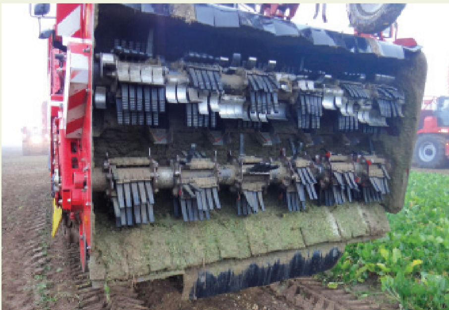
Foto 5: Ontbladeraar met dubbele rotor. De stalen klepels verwijderen het grootste deel van de bladeren terwijl de rubberen klepels de laatste bladresten wegpoetsen.
