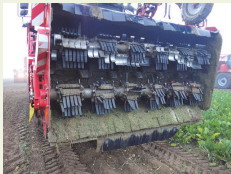
Photo 3 : Effeuilleuse à double rotor. Les fléaux en acier enlèvent la plupart des feuilles tandis que les fléaux en caoutchouc éliminent les restes de feuilles.
