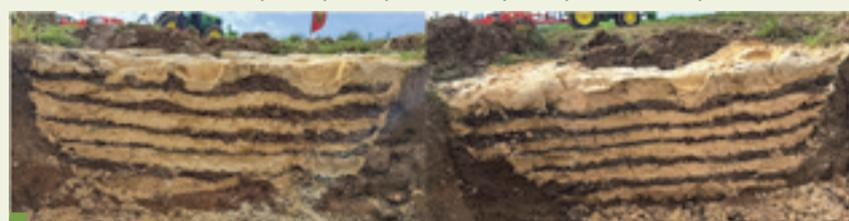
Figure 4 : à gauche : essieu avant, 4,4t/roue, pression 1,1 bar ; à droite : essieu arrière, 5,2t/roue, pression 1,7 bar
